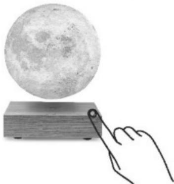
**Paso 5:** La luna se encenderá en cuanto esté suspendida adecuadamente. De no ser así, encienda o apague la lámpara. También puede intentarlo al cambiar el modo de la luz. Para ello, toque el botón de control táctil en la parte inferior derecha de la base
